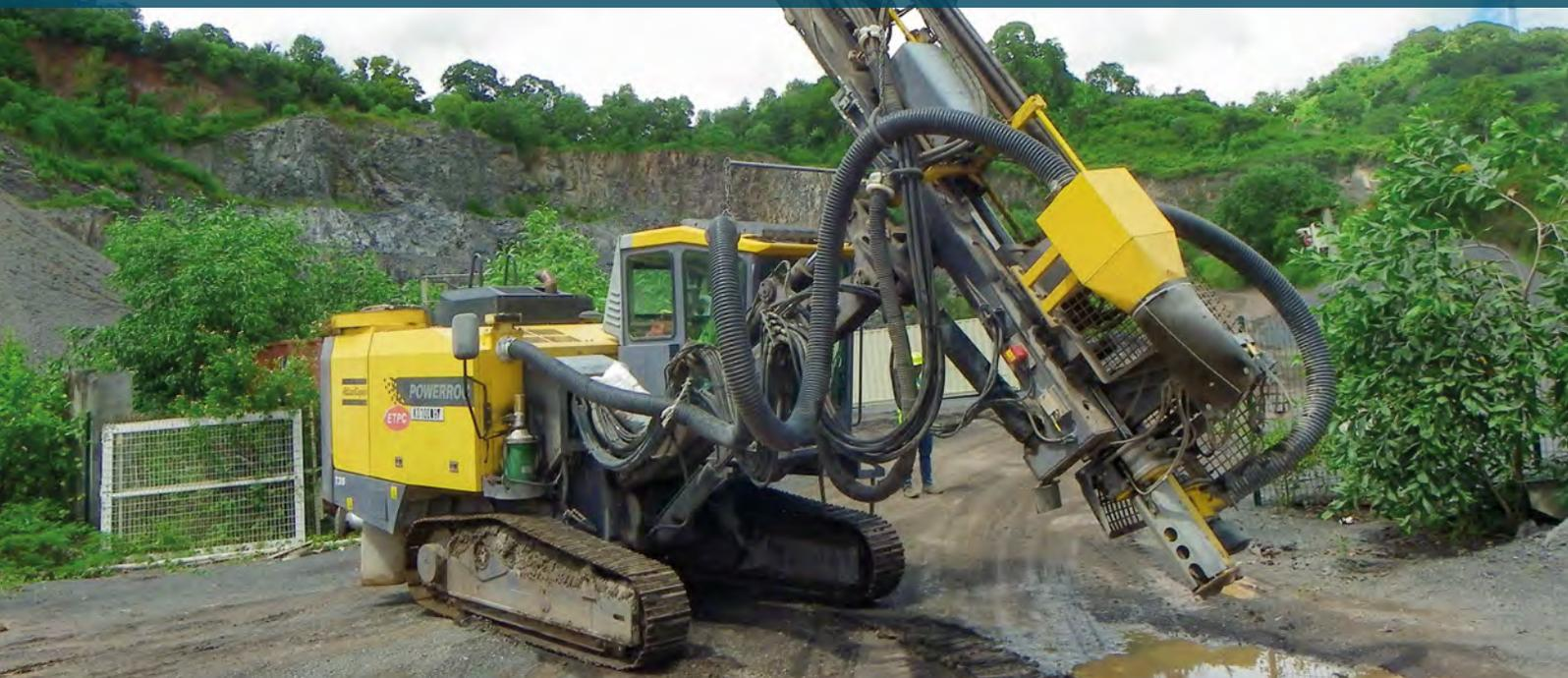
Réaliser des trous destinés à la mise en œuvre des mines avec une foreuse hydraulique.
