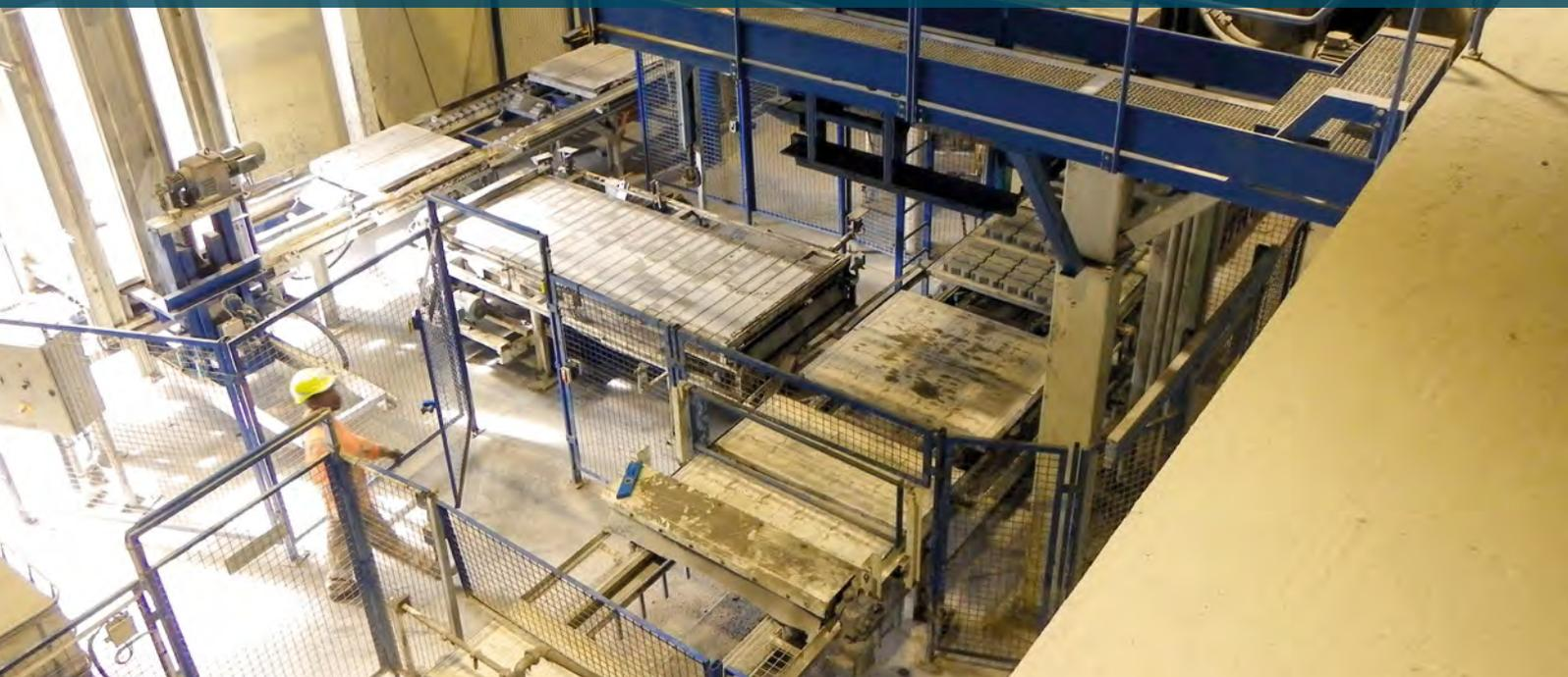
*Conduire ou surveiller une installation de production de matériaux, vérifier et contrôler sa production de parpaing, bordure, pavé.*
